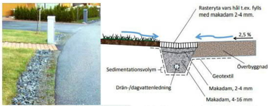
Figur 11. Makadamdike mellan lokalgata och tomtmark samt principskiss av ett makadamdike. Bildkälla: WRS
